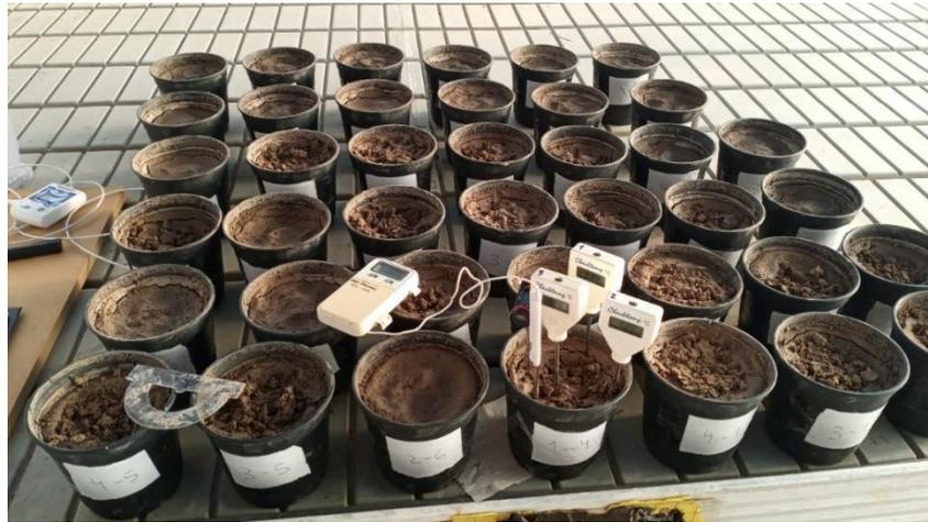
Figura 2. Distribución de las 40 muestras numeradas, con los instrumentos de medida de temperatura, durante la segunda sesión de medida.
