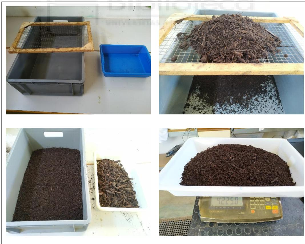
Figura 8. Detalle de la preparación de la muestra de compost previa al bioensayo con lombrices. Material para tamizado (Arriba izquierda), Tamizado de muestra (Arriba derecha), Fino 1 y bruto 1 (Abajo izquierda) y Obtención del Fino 1 (Abajo derecha).
