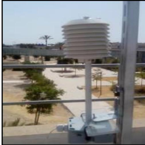
Imagen 2.9: Termohigrómetro exterior del circuito de calor
