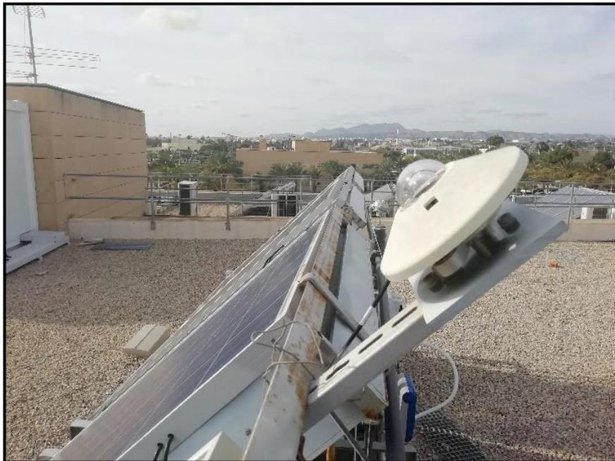
Imagen 2.10: Piranómetro situado en la parte superior de los paneles
