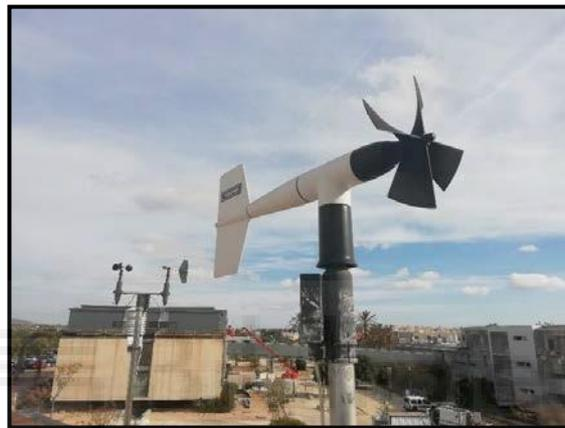
Imagen 2.11: Anemómetro de veleta en la instalación
