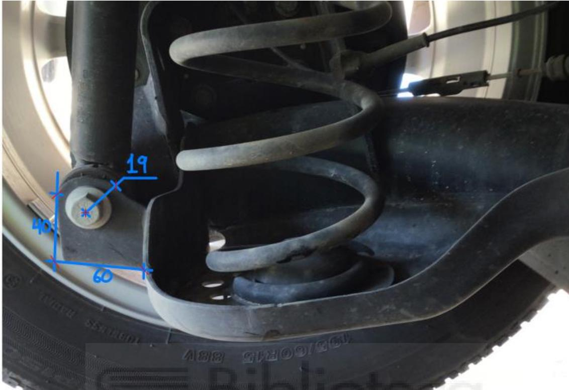
Imagen 1: Medidas soporte amortiguador\_1. Fuente propia.
