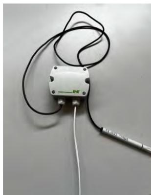
Figura 3.11 Sonda remota.
