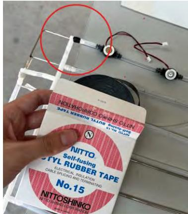
Figura 2.21 Fijación a través de cinta vulcanizable.
