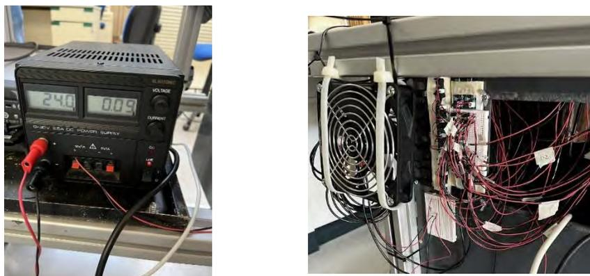
Figura 2.29 Fuente de alimentación utilizada para el ventilador y disposición del ventilador
