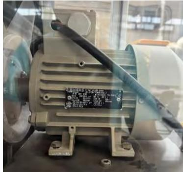
*Figura 3.05 Motor eléctrico acoplado al ventilador.*
