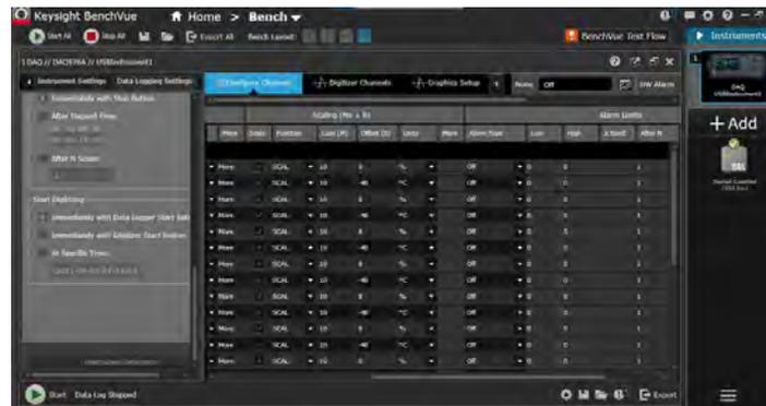
Figura 4.07 Introducción del ajuste Gain, Offset y unidades.
