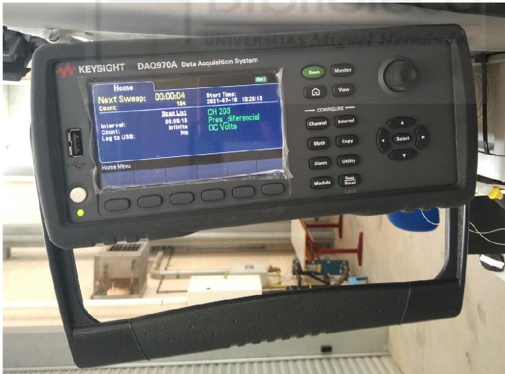
*Figura 28 Sistema de adquisición de datos*
