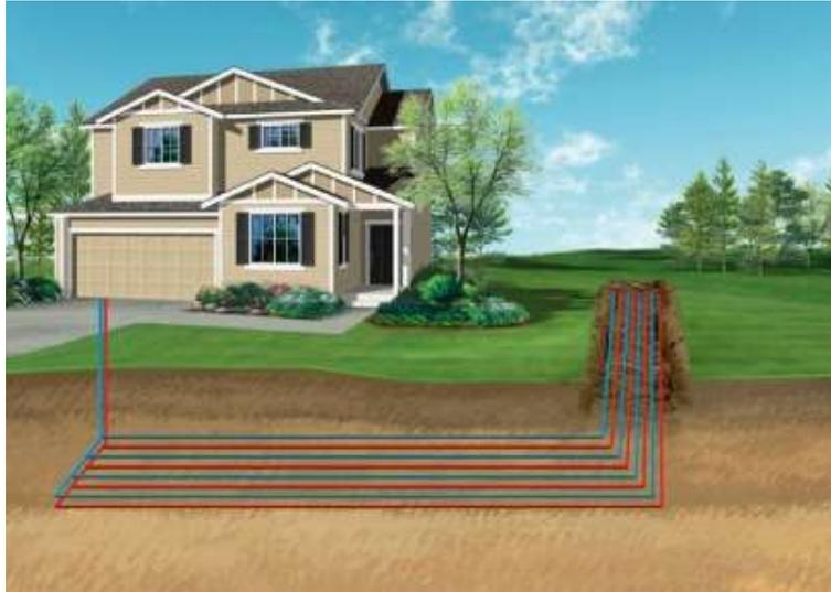
IMAGEN 5. INSTALACIÓN GEOTÉRMICA HORIZONTAL O DE BAJA ENTALPIA.
