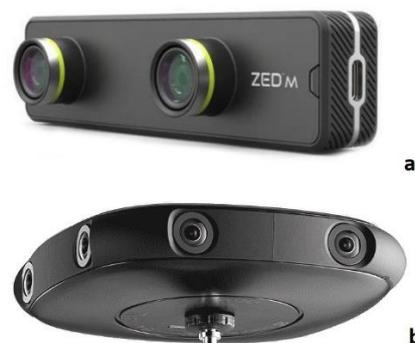
Figura 6: a) Cámara estéreo binocular; b) Cámara estéreo omnidireccional.
