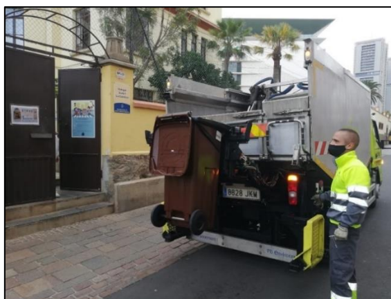
Imagen 4. Recolector híbrido carga trasera 7 m 3
