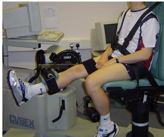
Figura 1. Dinamómetro isocinético 'Cybex NORM' (Wilcock et al., 2008).
