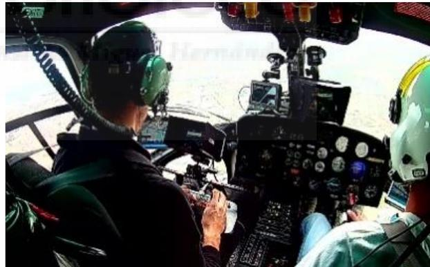
Figura 32.1. Cámara, sistema inalámbrico y control de cámara en el helicóptero. Fuente: Mediapro. 2021.
