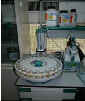
Fotografía 2. Valorador automático de la acidez de las muestras de plátano
