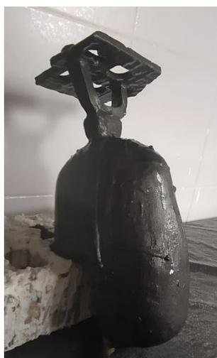
Fig. 7. Árbol de colada completo con su primer baño de grafito y sílice coloidal. Modelo de la pieza 'Fachada'.
