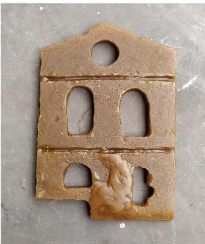
Fig. 6. Modelo en cera de la pieza 'Fachada'.
