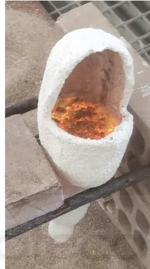
Fig. 9. Detalle del momento que la pieza se gira para que el metal fundido se introduzca en el interior del molde hasta que se enfríe. Modelo de la pieza 'Bolo'.
