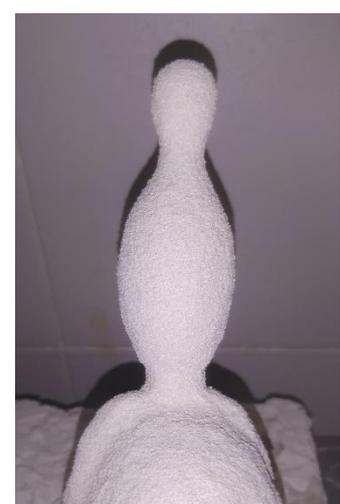
Fig. 8. Árbol de colada completo con su primer baño de papilla de moloquita y sílice coloidal más moloquita de grano fino. Modelo de la pieza 'Bolo'.
