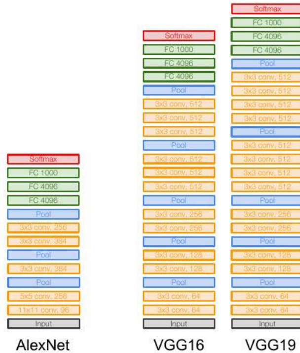
Figura 3.3. Capas utilizadas para diferentes arquitecturas. Se compara AlexNet con arquitecturas desarrolladas posteriormente.
