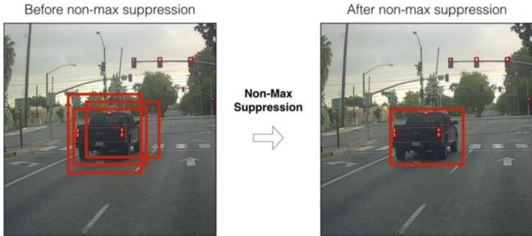
Figura 4.1. Supresión de No Máximos para converger a una caja envolvente final cuando hay multiples cajas envolventes predichas por el algoritmo de detección de objetos [19].
