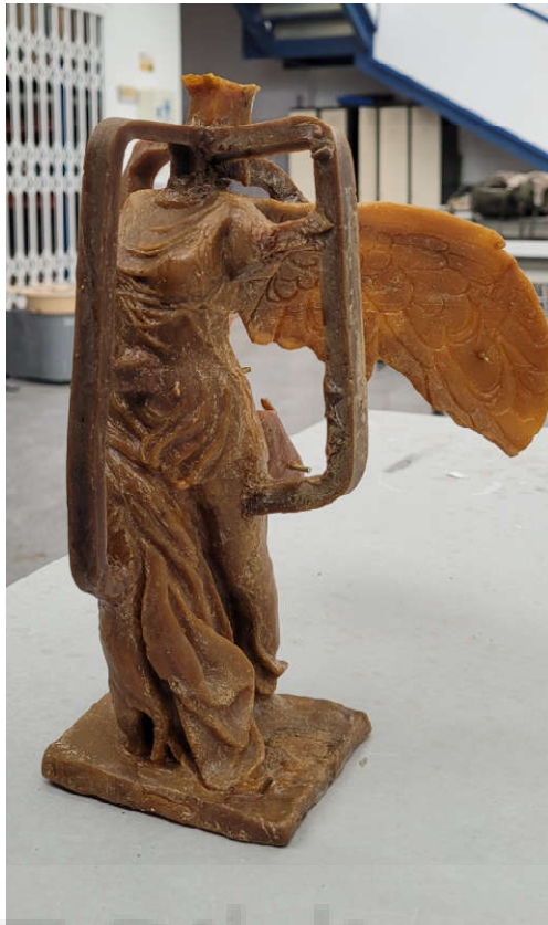
Fig.3. Modelo en cera ya con bebederos.
