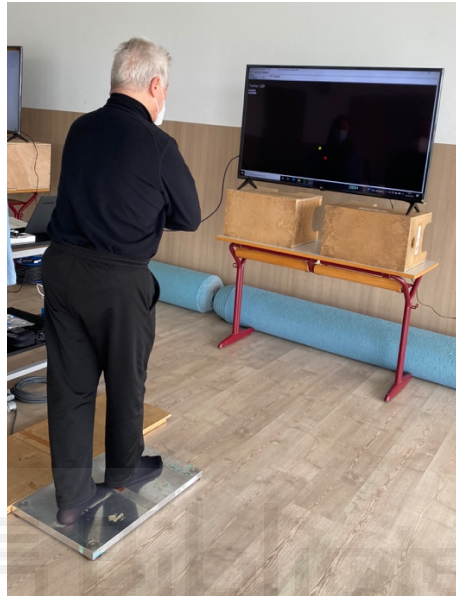
Figura 3. Imagen de un participante durante la ejecución del Tandem Stance Balance Test con feedback visual sobre plataforma de fuerzas.
