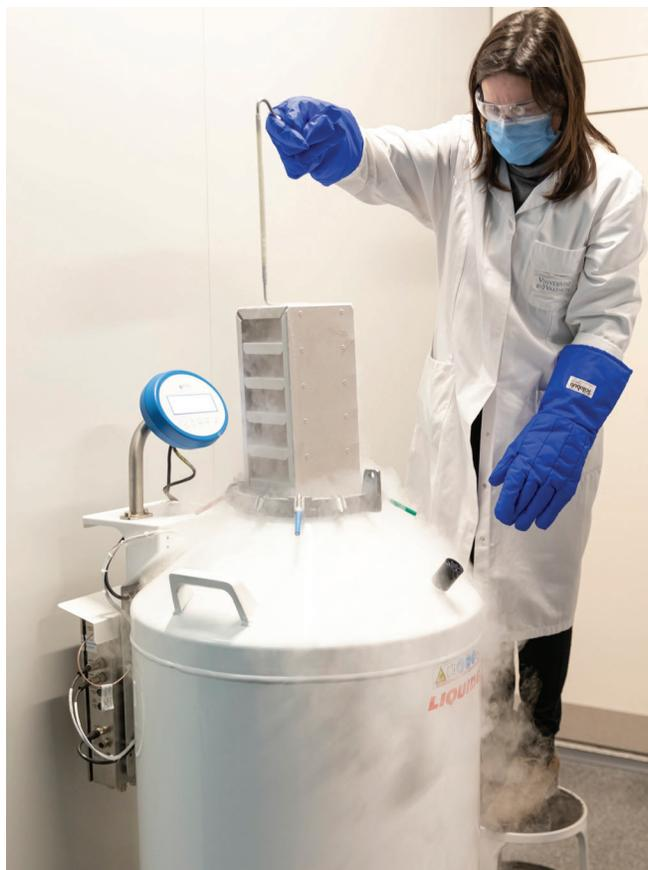
Figura 5. Conservación en nitrógeno líquido.
