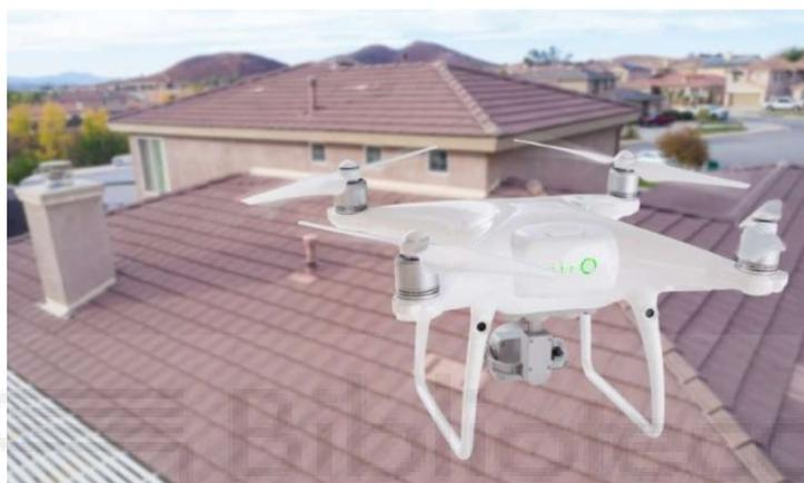
Figura 60 – Uso de drones para el replanteo de cubiertas no transitables.
