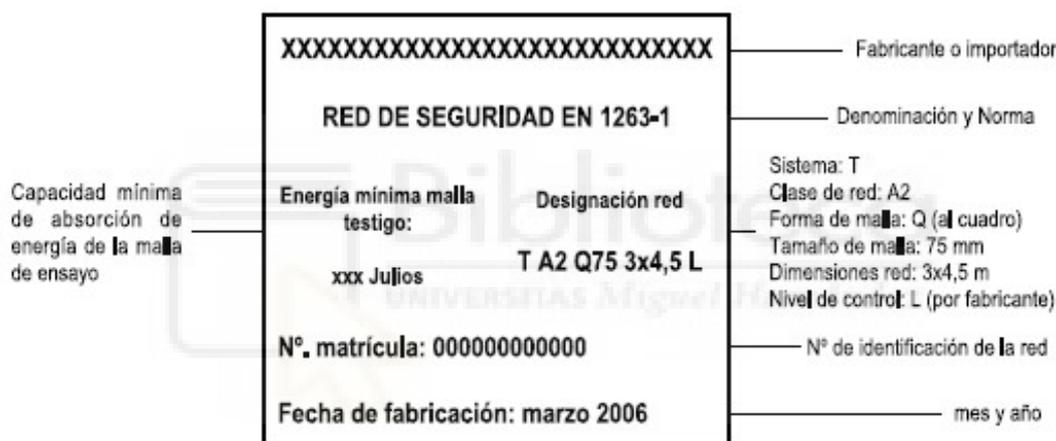
Figura 35 – Ejemplo de etiquetado conforme UNE-EN 1263-1.
