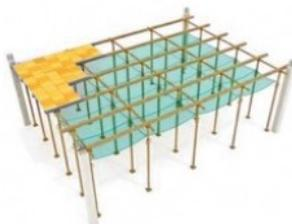
Figura 32 – Red Anticaída sistema S.
