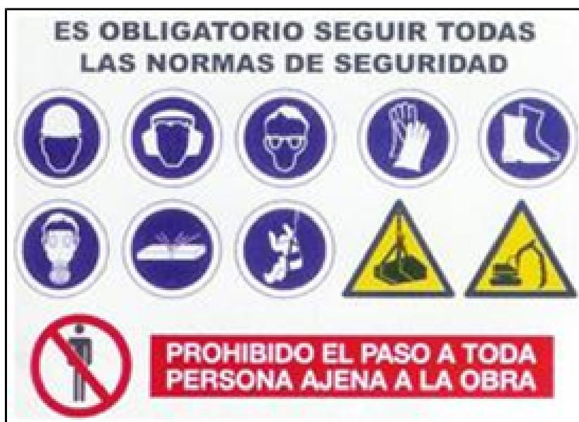
Figura 40 - Señalización de la obra conforme a RD 485/1997.
