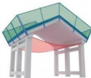
Figura 31 – Red Anticaída sistema V.
