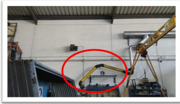
*Foto zona de trabajo con extractor de gases*
