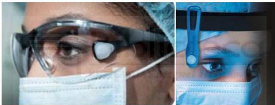
**Figura 5.** Dosímetro de cristalino, tomada de Jaramillo et al <sup>(27)</sup>.
