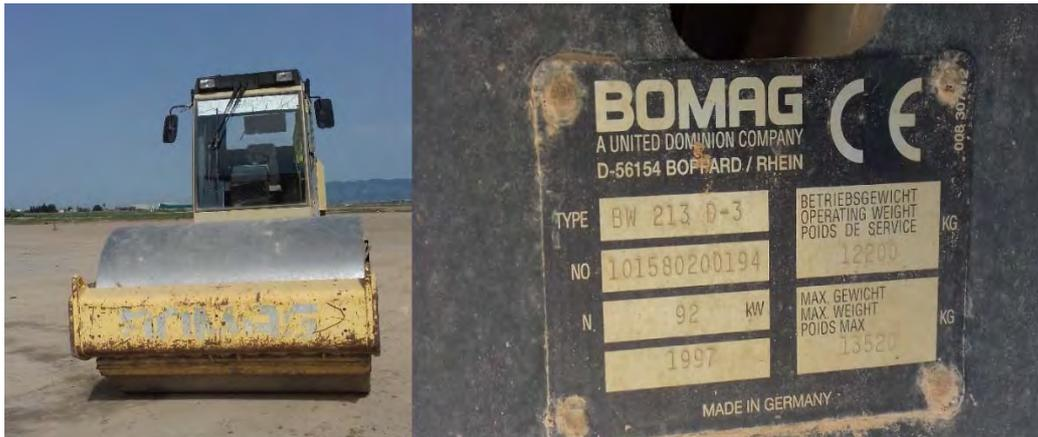
Imagen 13. Ejemplo de máquina de compactación de tierra y su correspondiente placa de características con marcado CE
