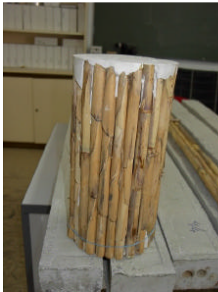
Fig.4.112. Probeta de caña con mortero de cal.
