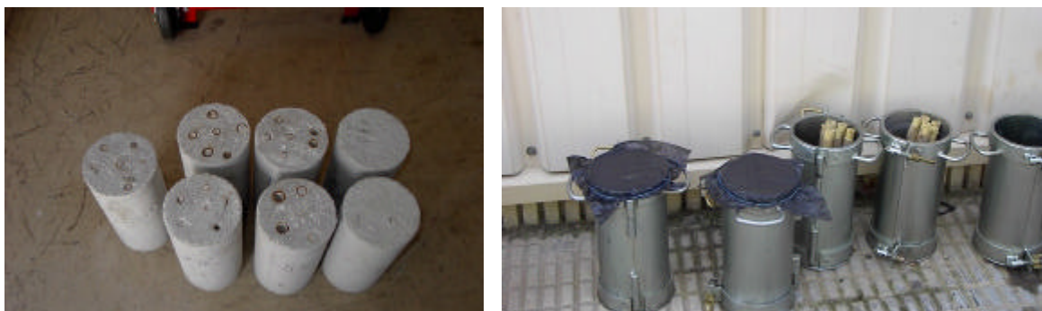
Fig. 4.93. Probetas de hormigón-caña.
