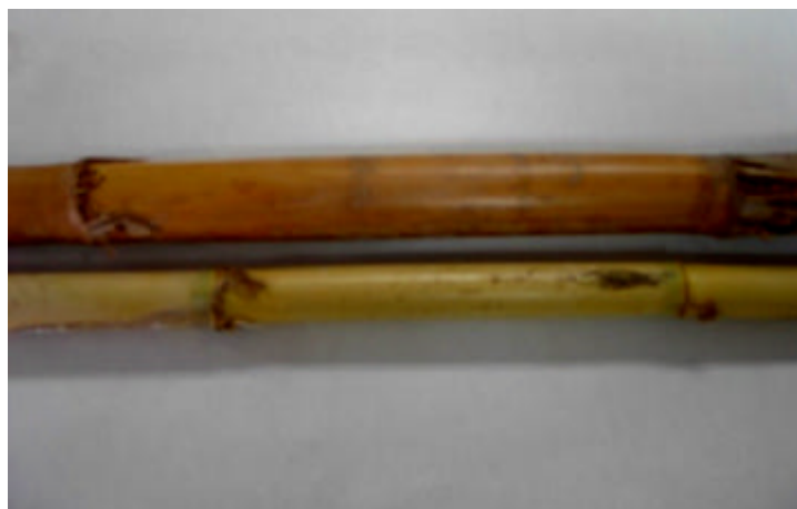
Fig. 4.43 . Caña común de una edificación del siglo XVIII y caña de tres años.
