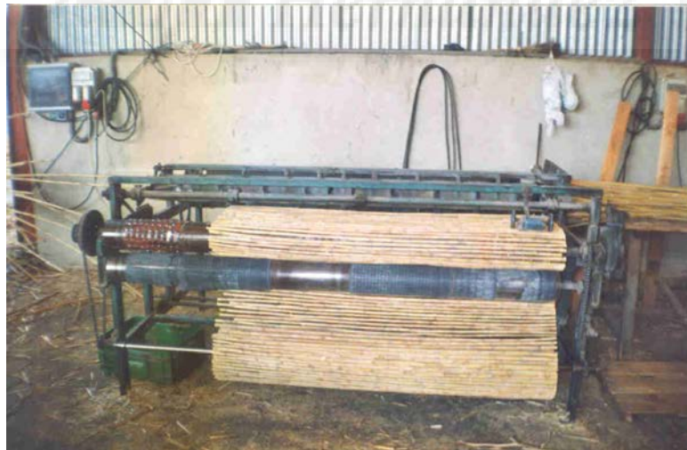
Fig. 1.21. Máquina tejedora de cañizo.
