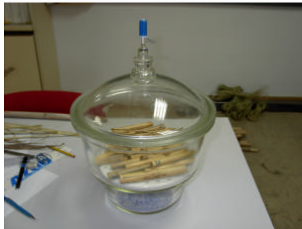
Fig. 4.31. Muestras de cañas secadas en estufa y mantenidas hasta el ensayo en un desecador.
