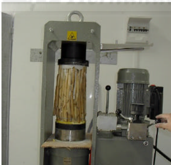
Fig. 4.113. Ensayo a compresión de una probeta de mortero de cal y cañas.
