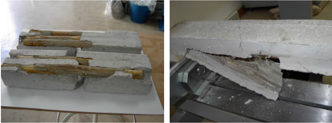
Fig.4.111. Restos de probetas de hormigón-cañas que se han sometido a flexión.
