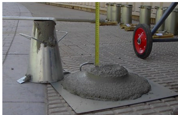
Fig. 3. 17. Asiento del mortero de cemento.
