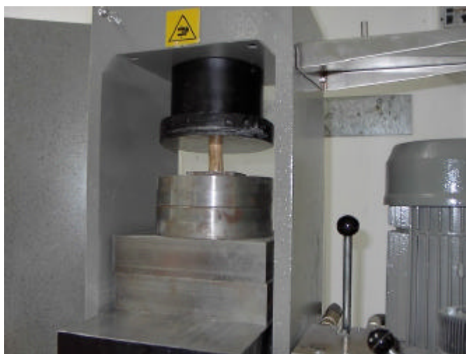
Fig. 4.44.. Prueba de ensayos de rotura a compresión paralela a las fibras de la caña común ( Arundo donax L. ).
