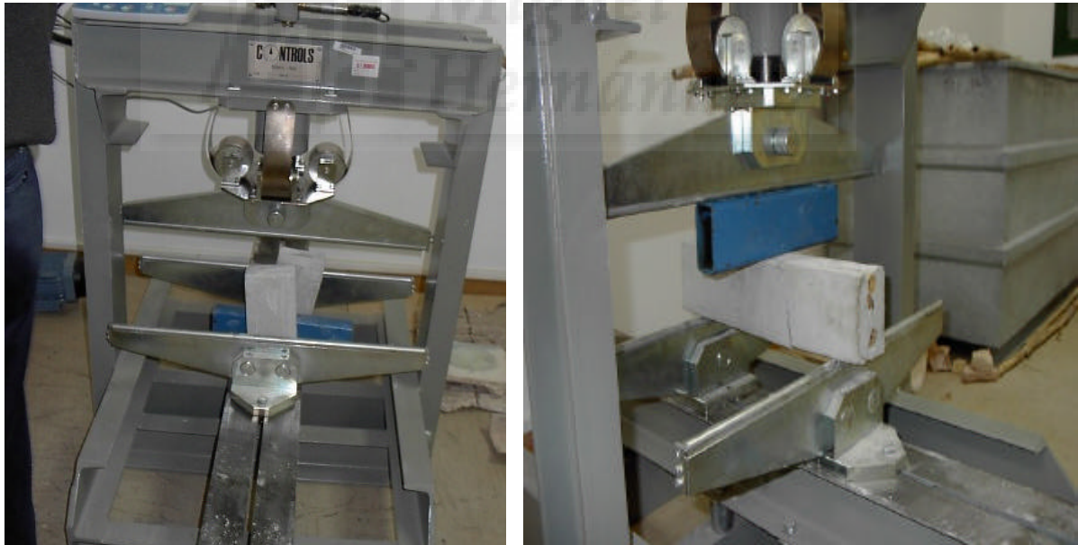
Fig. 4.103. Ensayos a flexotracción con probetas de mortero de hormigón y probetas de hormigón-cañas.
