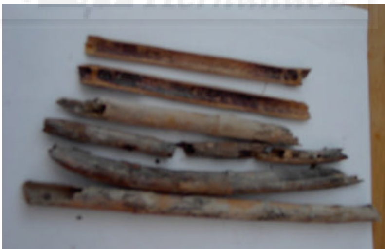
Fig. 4.40. Cañas descompuestas por hongos.
