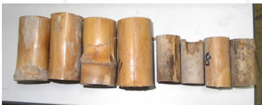
Fig. 4.45. Muestras de caña antigua rotas en el ensayo.
