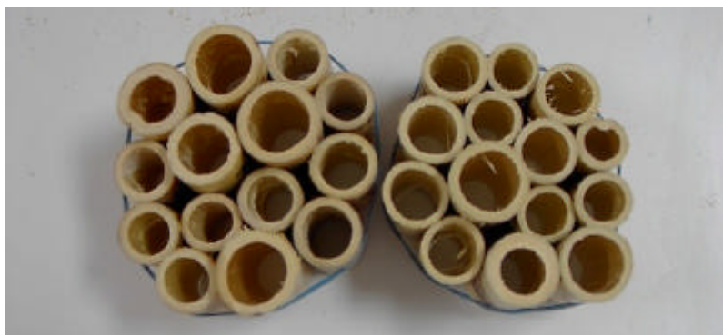
Fig. 4.25. Diferentes diámetros y espesores de caña común.
