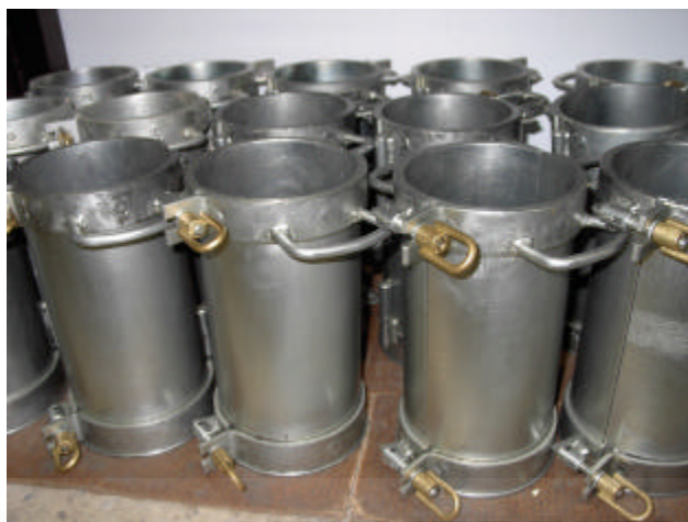
Fig. 3.12. Moldes de probetas cilíndricas.
