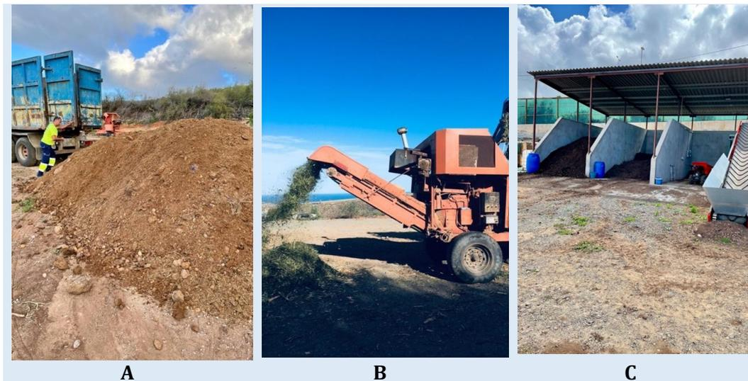
Figura 18. Distintas etapas en el flujo de producción: A )Recepción de estiércol de cabra B) Trituración de restos de poda de jardinería C)Afino y cribado del material obtenido
