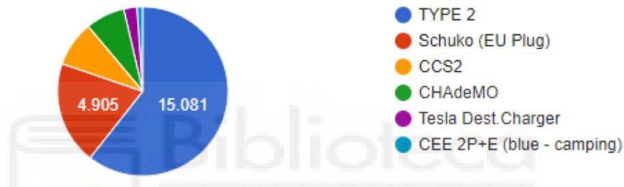
Figura 15. Distribución de los conectores en los puestos de carga de España [6]
