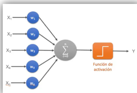
Ilustración 26: Estructura de red neuronal monocapa
