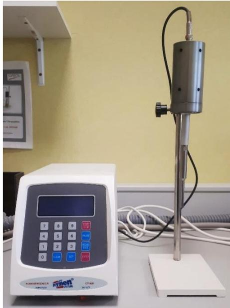
*Figura 8: Homogeneizador por ultrasonidos modelo CY-500 de COMECTA SA.*
