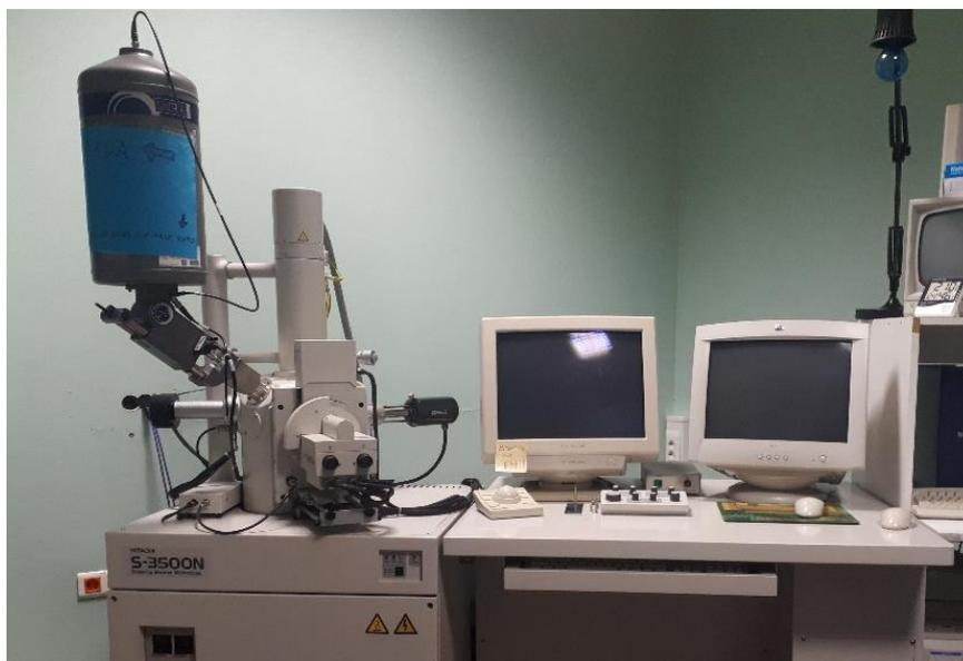
*Figura 11: Microscopio electrónico de barrido (MEB-Hitachi S-3500N, Ibaraki, Japan); Microanálisis de energía dispersa de rayos-X (EDX; Oxford Link Analytical).*
