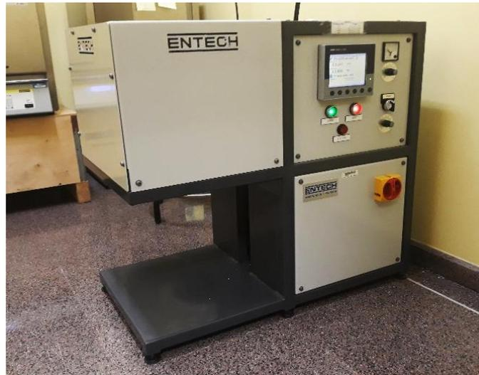
*Figura 5: Horno de alta temperatura ENTECH, referencia EEF 1/17.*
