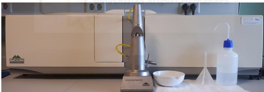
*Figura 10: Laser de difracción Mastersizer2000E device-Malvern.*
