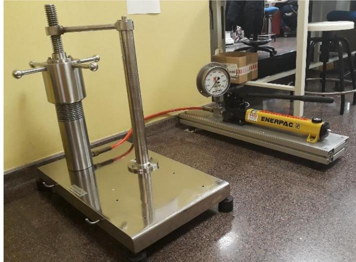
*Figura 4: Prensa isostática de ASTUR SINTER, SL y bomba manual P-2282 de ENERPAC.*
