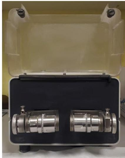
*Figura 6: Molino vibratorio MM301 de Retsch.*
