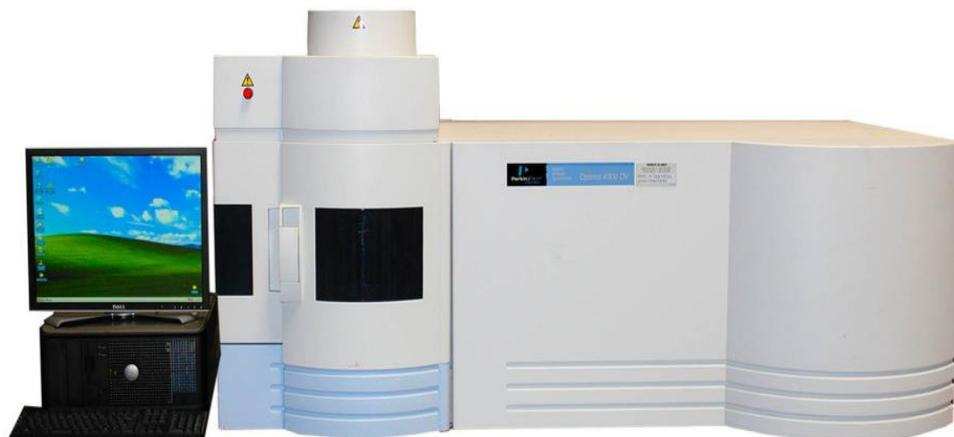
*Figura 15: Espectrómetro de emisión óptica PerkinElmer Optima 2000™ DV.*
