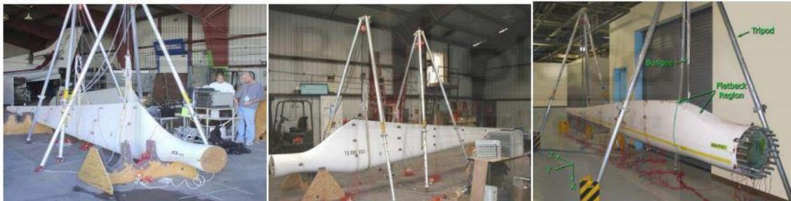
*Figura 10: Las tres aspas estadounidenses siendo sometidas a ensayos. Fuente: Griffith D.T., Carne T.G. (2011) Experimental Modal Analysis of 9-meter Research-sized Wind Turbine Blades. In: Proulx T. (eds) Structural Dynamics and Renewable Energy, Volume 1. Conference Proceedings of the Society for Experimental Mechanics Series. Springer, New York, NY.*
