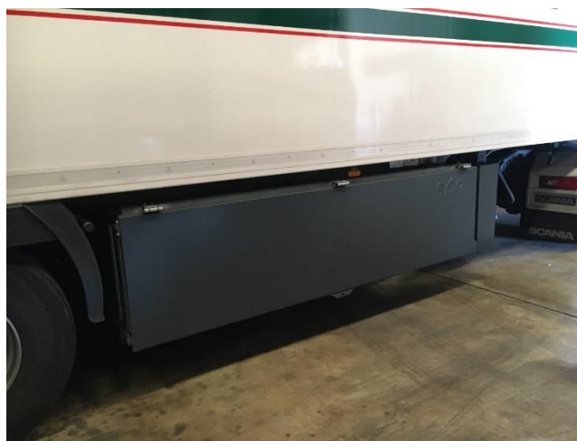
Figura 26 : Porta-palets del semirremolque frigorífico. Fuente: Autor
