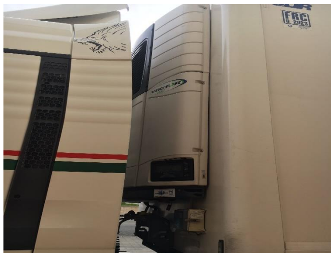
Figura 22 : Equipo frigorífico del semirremolque. Fuente: Autor
