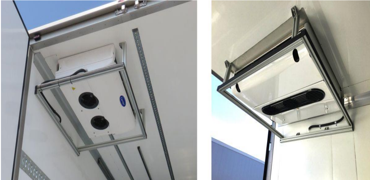
Figura 45: Ejemplo de evaporadores multi temperatura en semirremolques frigoríficos. Fuente: Autor.
