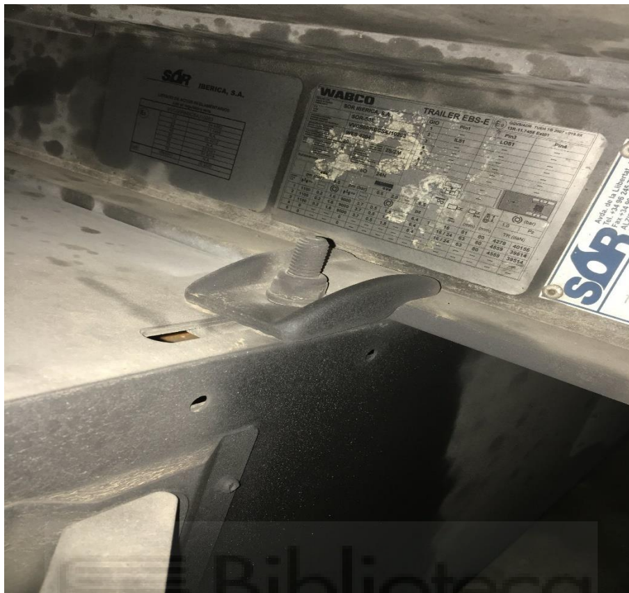
Figura 46: Método de fijación del porta-palets al chasis del semirremolque . Fuente: Autor.
