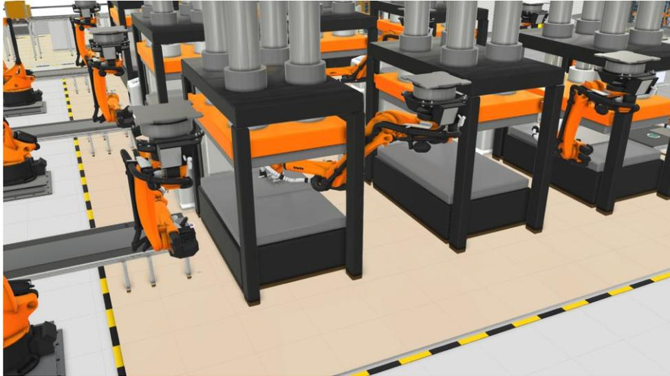
Figura 33. Robot sacando una plancha tras el primer prensado para introducirla en la segunda prensa.
