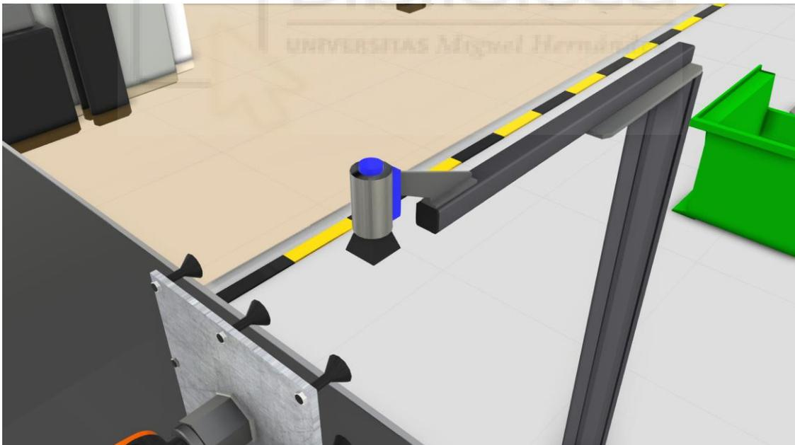
Figura 37. Cámara detectora de fisuras y pequeños defectos.
