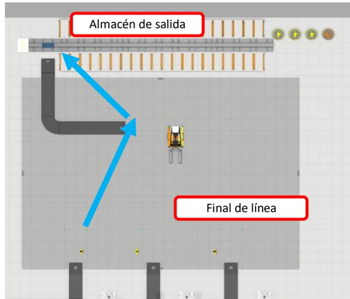
Figura 21. Flujo simplificado del almacén de salida.
