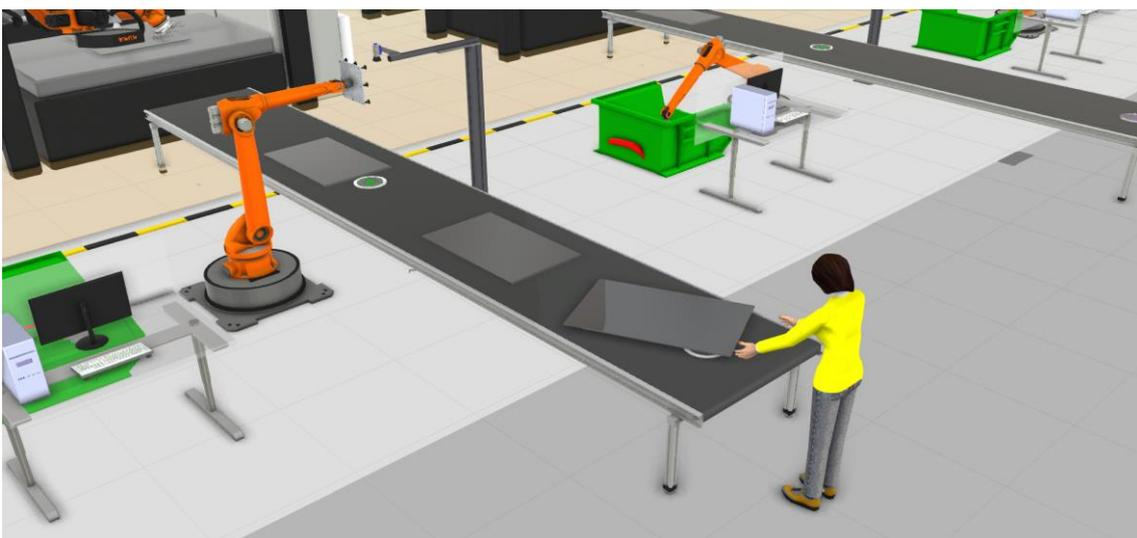
Figura 39. Operario retira el producto de la cinta transportadora para paletizarlo.
