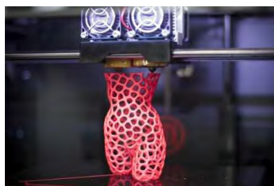
Figura 28. Tecnología de deposición fundida, la más popular de la impresión 3D. [Fuente:
