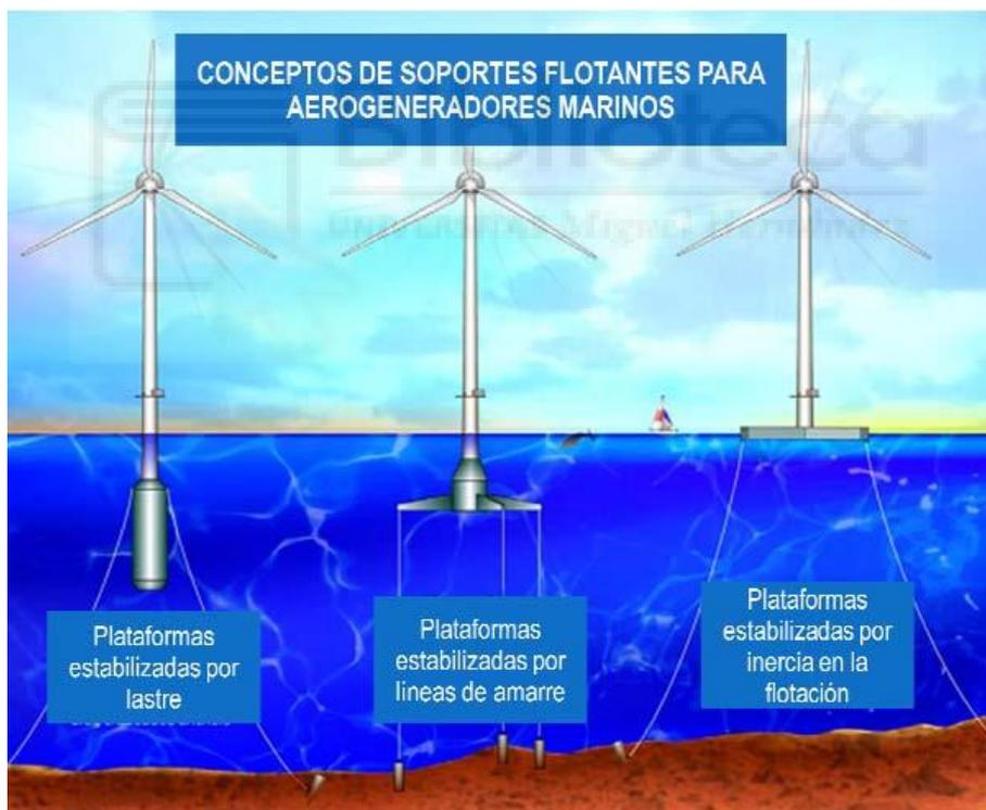
*Figura 21 Tipos de plataformas flotantes [21]*
