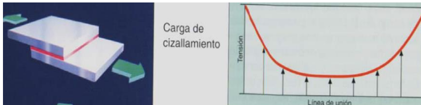
Figura 21. Distribución de tensiones en una unión adhesiva frente a un esfuerzo de cizalladura
