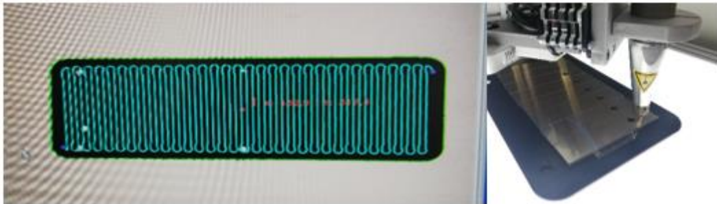
Figura 52. Líneas de trayectoria y aplicación del plasma atmosférico sobre la superficie de AW-5754
