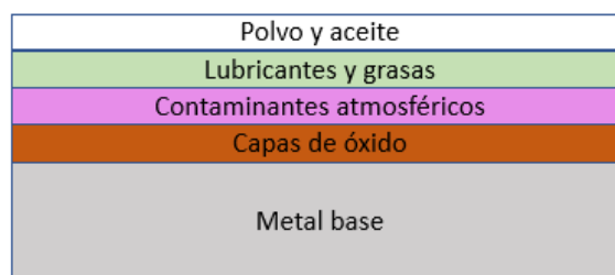
Figura 34. Posibles capas superficiales en un metal
