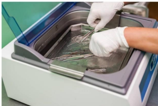
Figura 37. Limpieza superficial con baño de ultrasonidos
