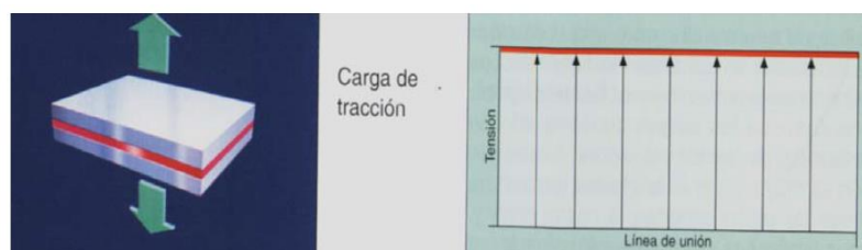
Figura 20. Distribución de tensiones en una unión adhesiva frente a un esfuerzo de tracción
