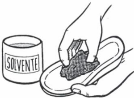
Figura 38. Limpieza de superficie mediante frotado con disolvente
