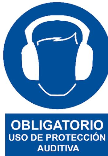
*Ilustración 33: Señal de protección obligatoria del oído*
