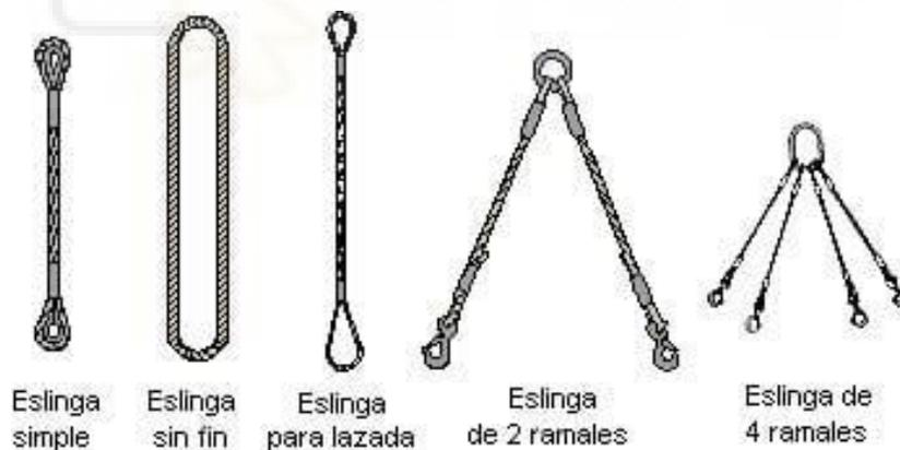
*Ilustración 13: Tipos de cables de acero*
