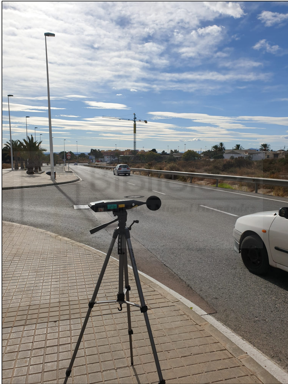
Figura 5 - Ejemplo de posicionamiento del sonómetro durante una medición.
