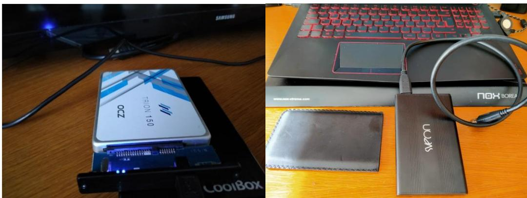
Figura 45: Carcasa para convertir disco duro interno en externo
