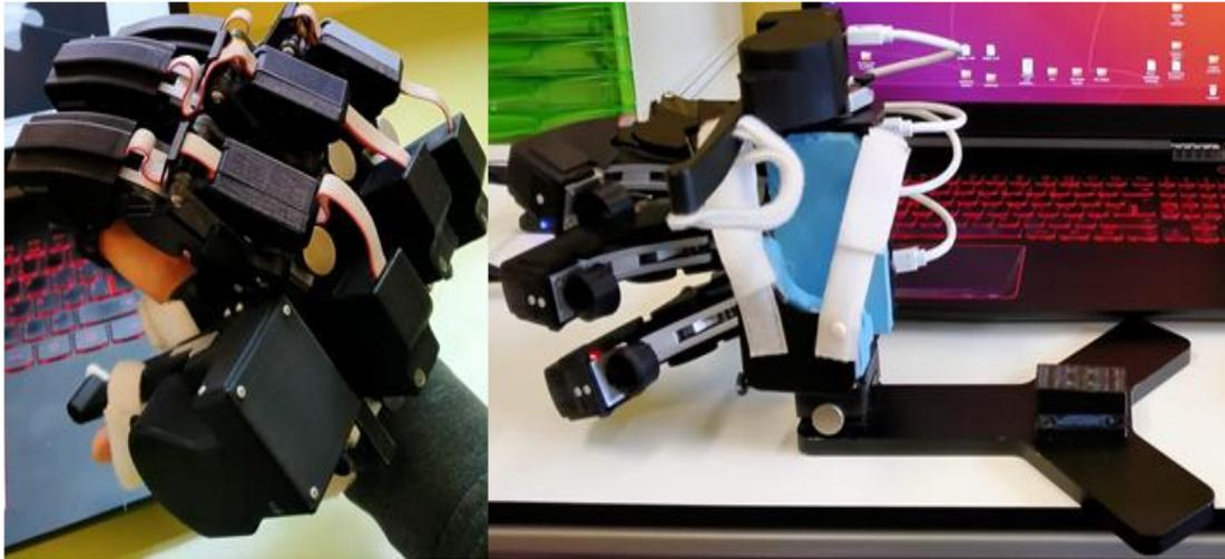
Figura 5: Dispositivo exoesqueleto de mano Helium
