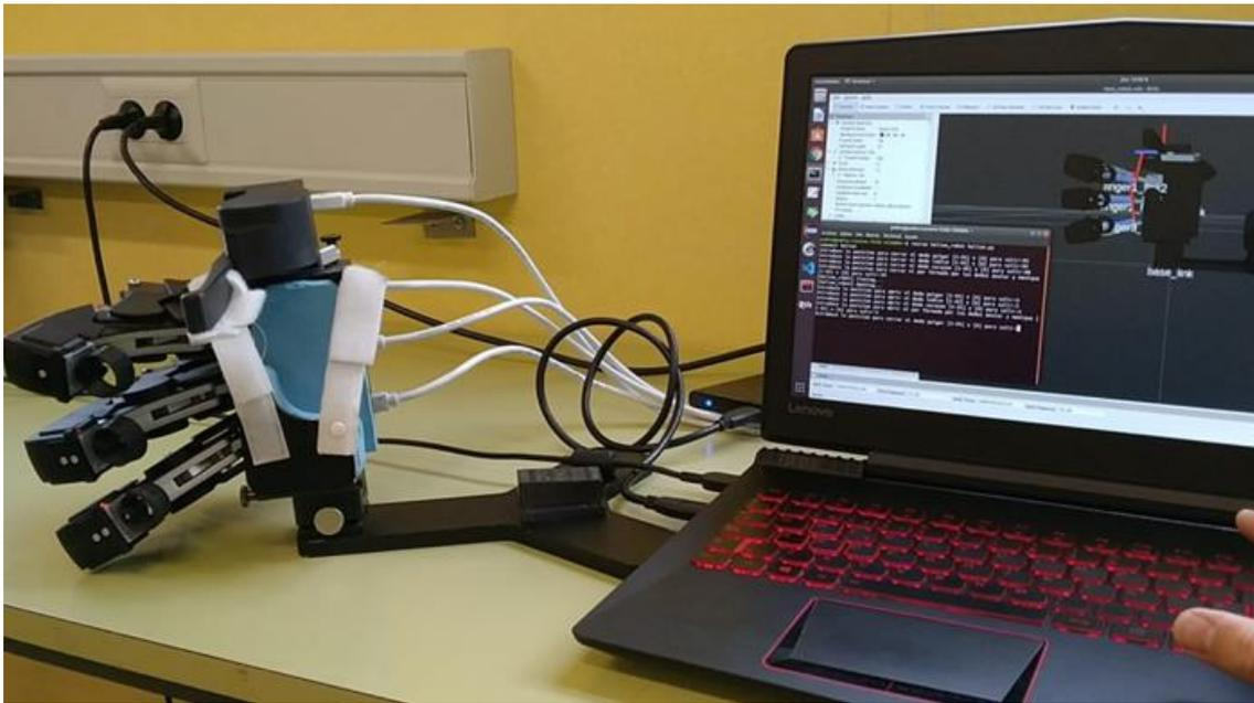
Figura 33: Visualización general de la posición de apertura del exoesqueleto
