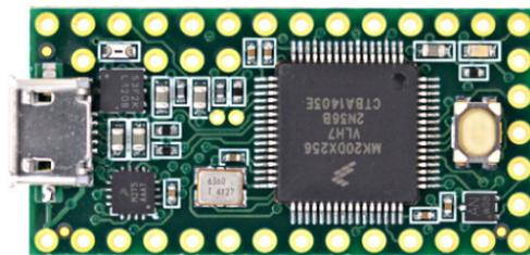
Figura 3.7: Cara superior del microcontrolador Teensy 3.2 de PJRC.
