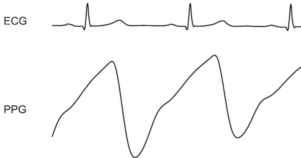
Figura 3.5: Señal ECG de pulso cardíaco y señal PPG. [7]
