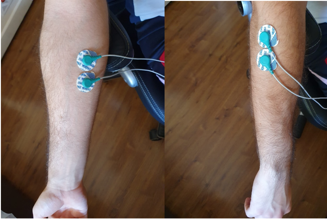
Figura 3.12 Colocación de electrodos para realizar adquisición de grupo muscular flexor a la izquierda y extensor digitorum a la derecha
