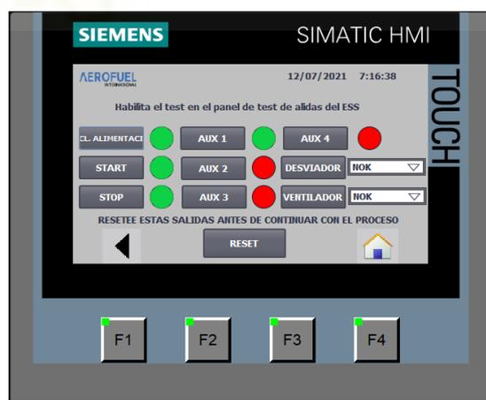
Figura 32. Pantalla prueba salidas
