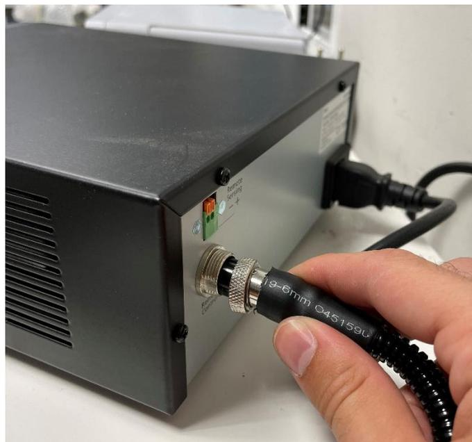
*Figura 42. Conexión control remoto fuente RW*
