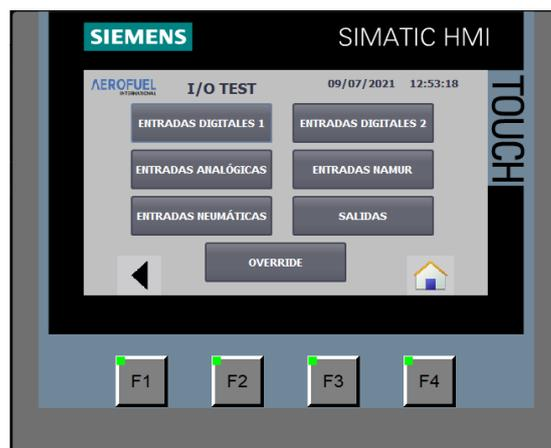
Figura 27. Menú prueba de entradas y salidas
