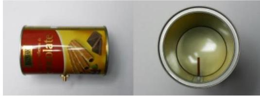
Figura 1.5. Guías de ondas circulares [8].
