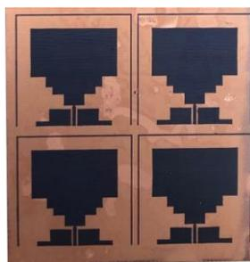
Figura 4.12. Proceso de revelado de las antenas.
