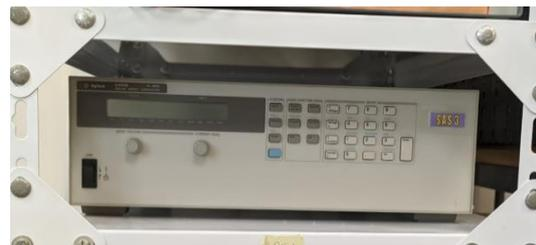
Figura 64. Fotografía de uno de los simuladores de paneles solares
