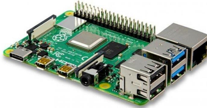
Figura 19. Imagen de la Raspberry Pi 4 Model B extraída de la página del fabricante
