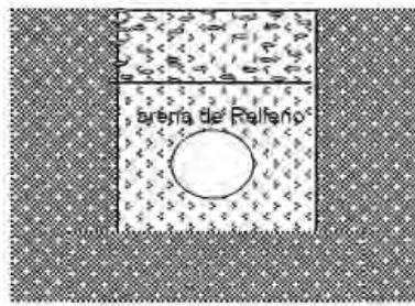
FIGURA 1.2: Canalización bajo tubo enterrada
