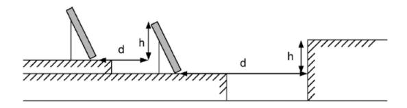
Como para nuestra instalación los módulos tendrán una altura de 0,55m una vez puestos encima de los soportes de forma horizontal y la latitud es de 39. 89º la distancia entre los módulos será de 1,42m.
