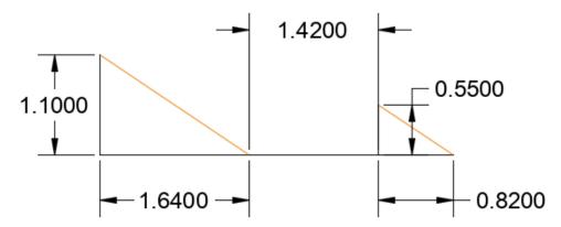
De esta forma tendríamos los módulos en dos posiciones diferentes, inclinados sobre su base (la mayoría de los módulos) o inclinados de costado (los tres de la fila inferior), ambos con la inclinación de 34º respecto al plano horizontal. El motivo por el cual tres de los módulos esta de costado es para que la distancia entre las filas no sea muy grande, ya que si ponemos los módulos de ambas filas sobre su base la distancia de separación ascendería a 2.84m y no cabría la fila en la superficie.
