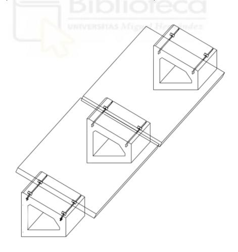
En total se necesitarán 17 soportes para colocar los 10 módulos de la instalación, quedando la configuración de la siguiente forma:
