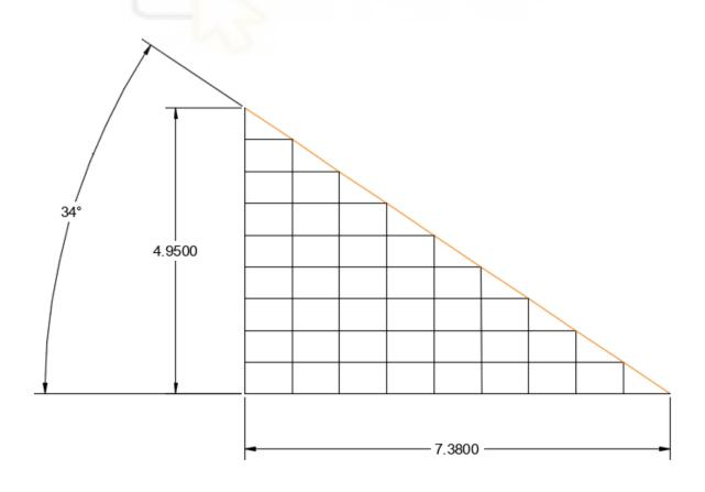
La inclinación de los módulos sería la óptima, 34º respecto al plano horizontal. En el caso de no necesitar tantos módulos, estos se colocarían en filas sobre soportes prescindiendo de las grandes estructuras.
