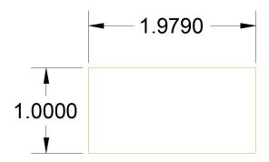
Al colocar estos en un ángulo de 34º respecto con el plano horizontal estando los módulos apoyados en el lado de 1.979m (posición horizontal) obtenemos que la altura de estos equivale a 0.55m respecto al suelo, resultado de multiplicar:
