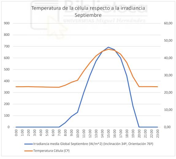
En estos resultados se puede observar como la temperatura de la célula se mantiene igual a la temperatura ambiente hasta que el módulo recibe irradiancia, momento en el que la temperatura asciende considerablemente.
