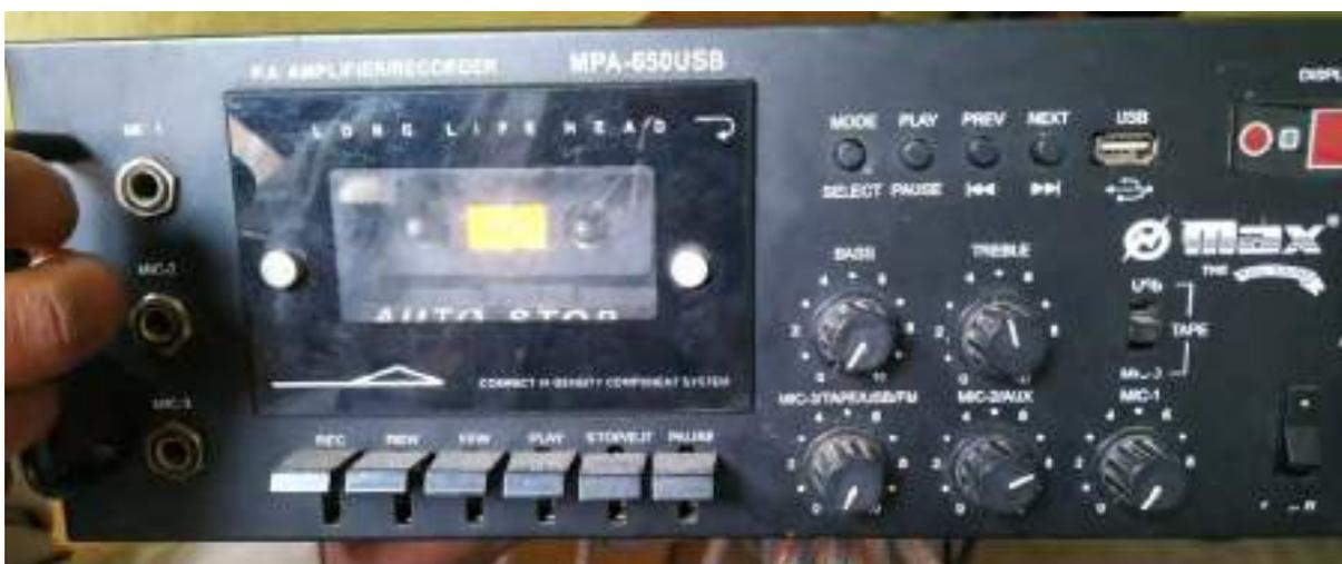
**Figura 5.17** - Parte frontal amplificador megafonía MPA-650 USB, ESSA Ruhengeri.
