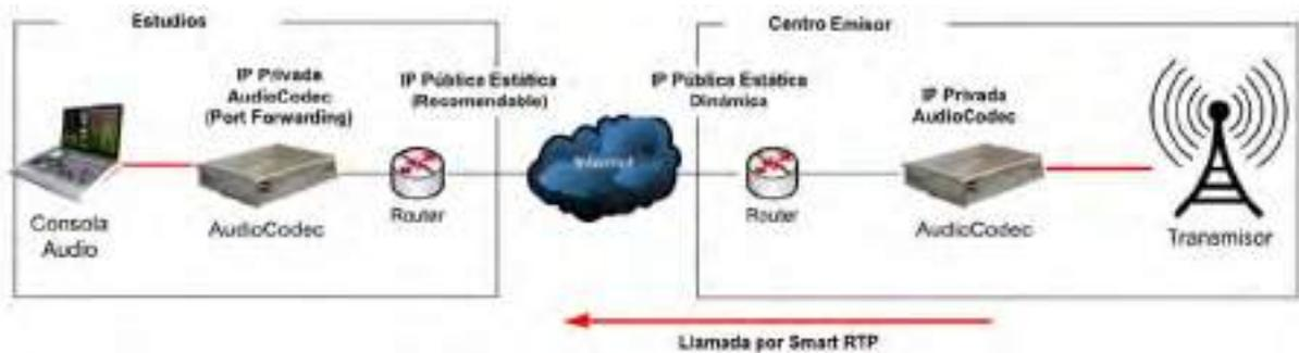
**Figura 4.8** - Esquema enlace STL a través de internet. (Fuente: AEQ)
