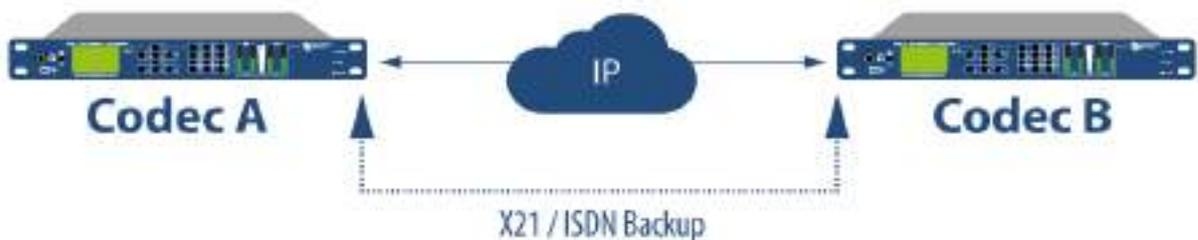
**Figura 3.23** - Esquema conexión Audio Códec IP. (Fuente: [Broadcaststoreeurope.com](http://Broadcaststoreeurope.com))
