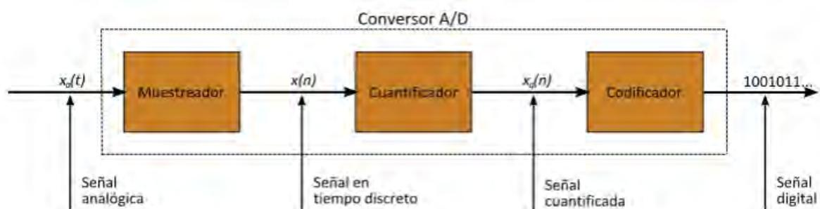
Figura 3.61 - Proceso de la conversión A/D. (Fuente: [Wikiwand.com](http://Wikiwand.com))
