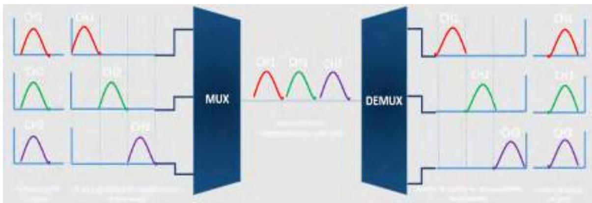
**Figura 3.29** - Ejemplo multiplexación - demultiplexación por división de frecuencia (FDM). (Fuente: [Electronicaradical.blogspot.com](http://Electronicaradical.blogspot.com))
