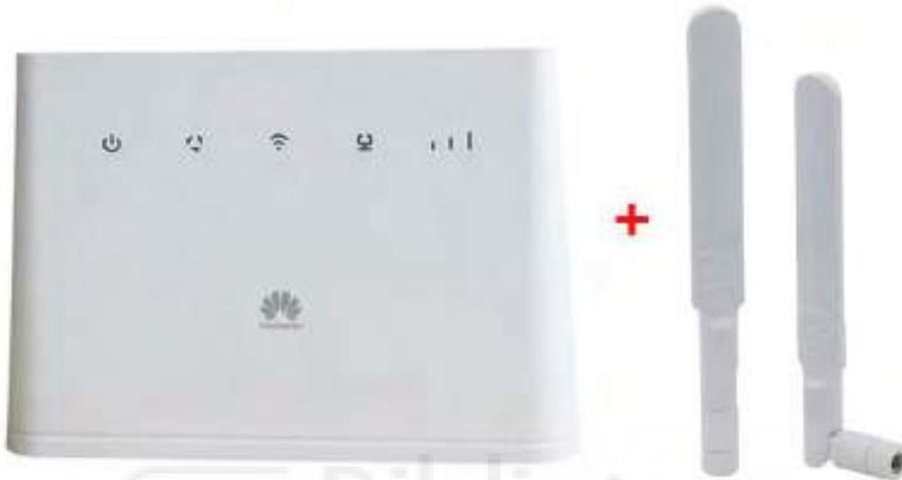
**Figura 4.14** - Router 4G Huawei B310S-2 con antenas externas. (Fuente: [Aliexpress](#))
