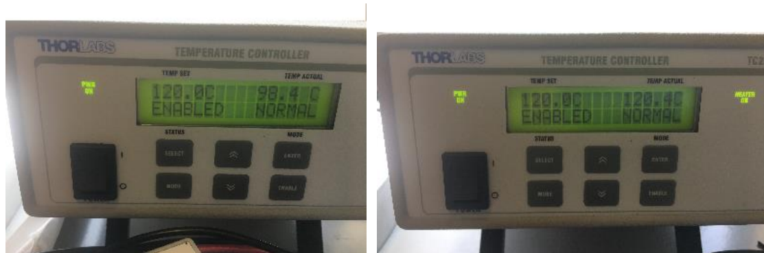
Figura 5.4. Máximas temperaturas alcanzadas en condiciones atmosféricas (IZDA) y de vacío (DCHA)
