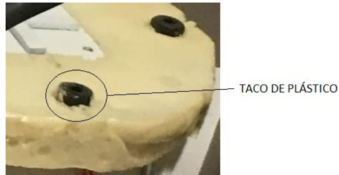
Figura 4.9. Detalle de los topes del portamuestras
