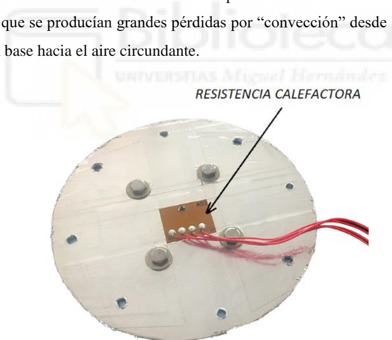
Figura 3.9. Ubicación de la resistencia eléctrica sobre el reverso de la base
