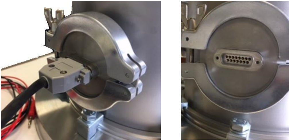
Figura 4.18. Cable de conexión del mando (IZDA) y conector pasamuros DB15 hermético (DCHA)
