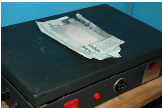
Calentamiento de la matriz, para fijar el resinado sobre la misma.
