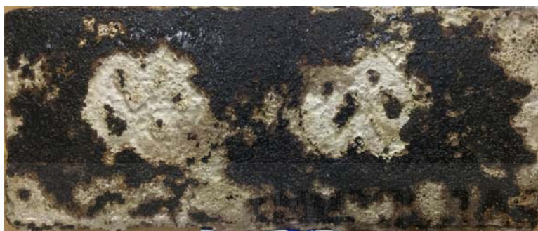
Plancha expuesta al Mordiente de Burdeos durante 48 horas
