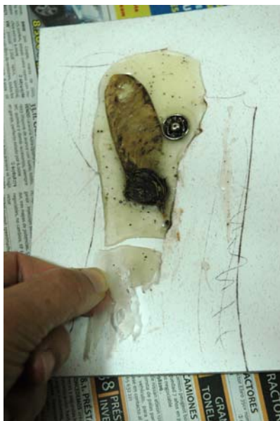
Desprendimiento del adhesivo
