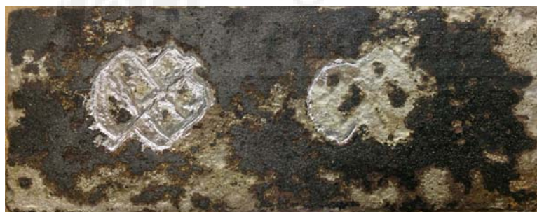
Plancha intervenida con la “Dremel” en una de sus huellas
