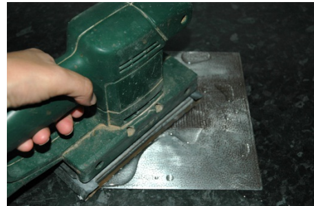
Desbaste de las maculaturas con lijadora eléctrica.
