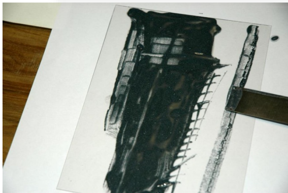
Mezcla de carborundo con Barniz de Poliuretano, aplicada con espátula.
