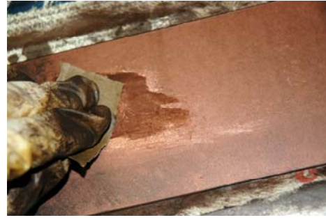
Desbaste con lija de agua y aceite de linaza.
