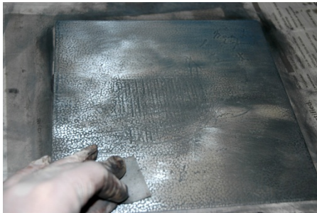
Lijado, a mano, para desbastar las maculaturas obtenidas en la matriz.
