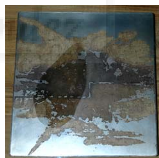
Ambas planchas unidas con "Epoxi".
