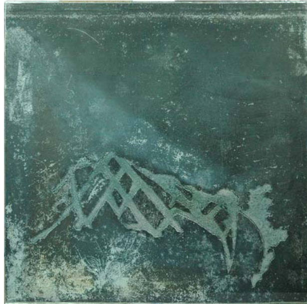
Resultado de la matriz después de la exposición al ácido
