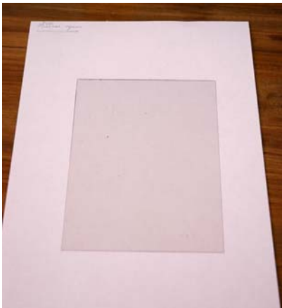
Matriz de PVC transparente, de 7 micras de espesor.
