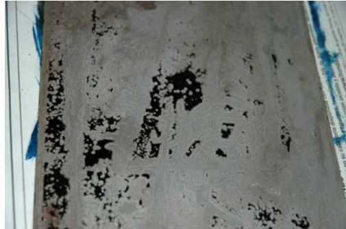
Corrosión del hierro defectuosa y poco pronunciada, por la acción del Mordiente de Edimburgo.
