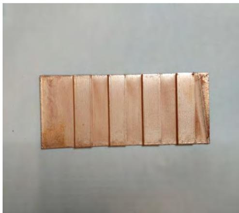
Figura 48: Metalización filtro paso banda tras su paso por el agitador
