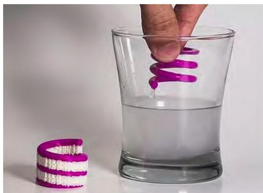
Figura 12: Pieza 3D impresa con material soluble [28].
