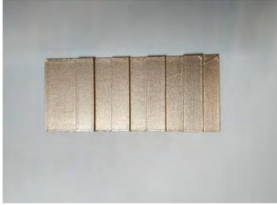
Figura 46: Metalización filtro paso banda
