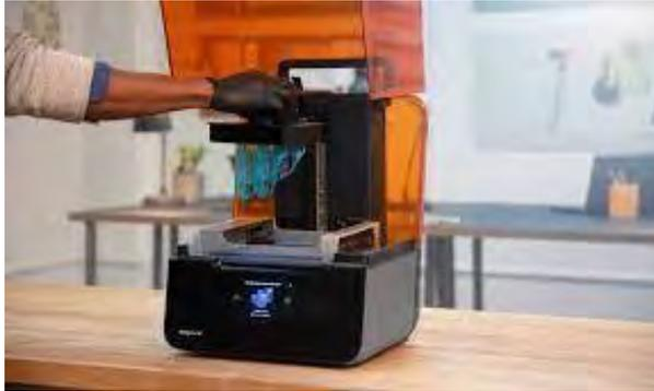
Figura 14: Impresora 3D basada en la técnica de SLA [15]
