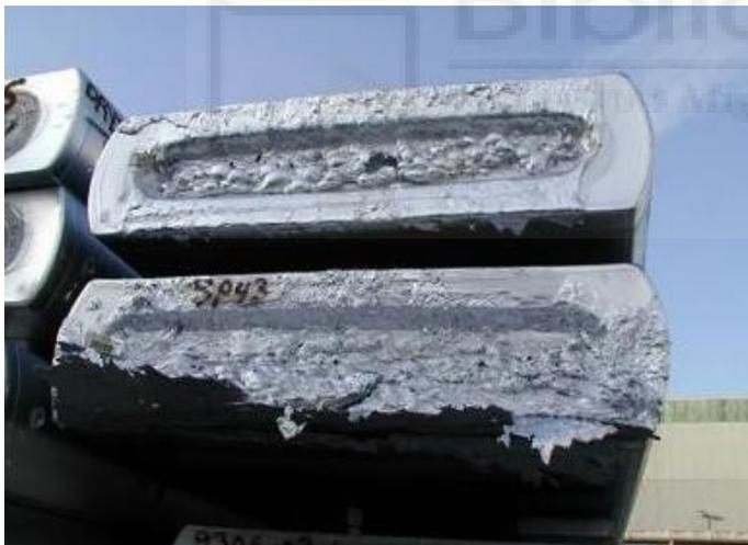
Ejemplo de muestras de agua en la parte final del lingote, el lingote cayó debajo del molde con el agua aún puesta y el agua expulsó el metal líquido.
