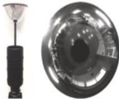
Figura 3. Sistema de visión catadióptrico con espejo convexo hiperbólico.
