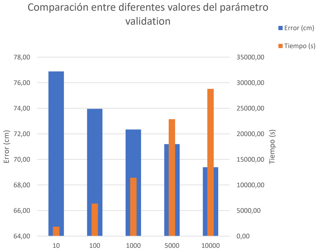
Figura 22. Comparativa entre diferentes valores del parámetro validation utilizando el descriptor ALEXNET, con day como imágenes de prueba y con data augmentation .
