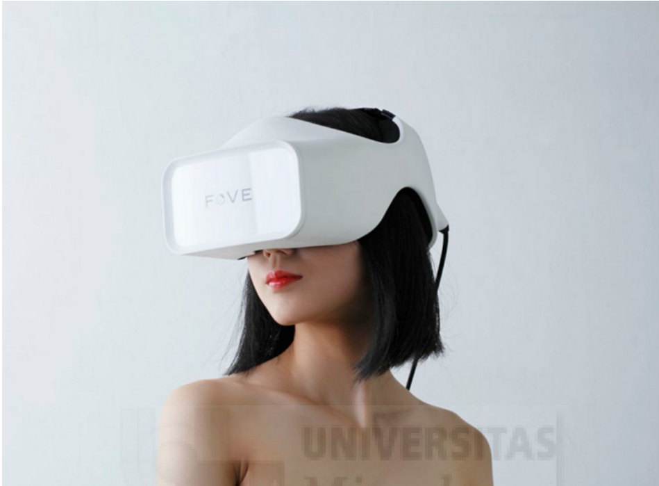
Imagen 71: FOVE, sistema de realidad virtual con eye-tracking integrado.
