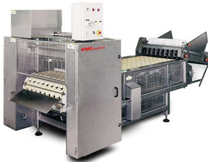
Figura 10, Deshuesadora de melocotón FMC y CTI modelo 300-A
