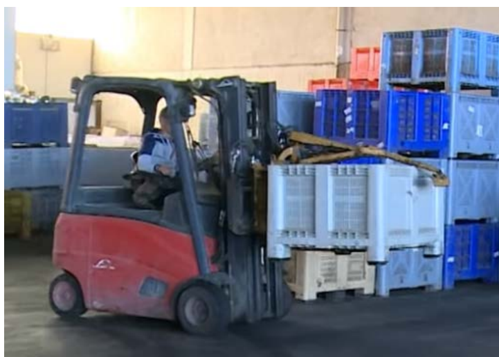
Figura 5, Descarga de cajas mediante carretillas
